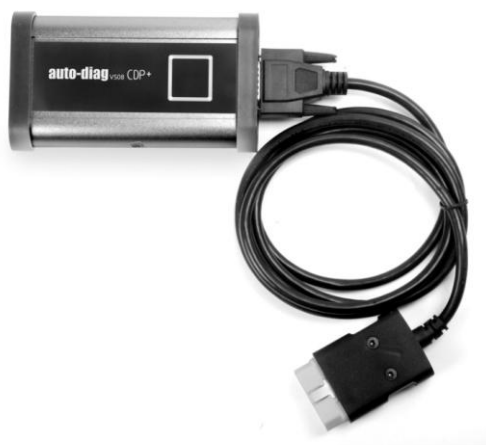
3.1.1 pav. „Autocom CDP Plus“ diagnostinis kompiuteris [1]
