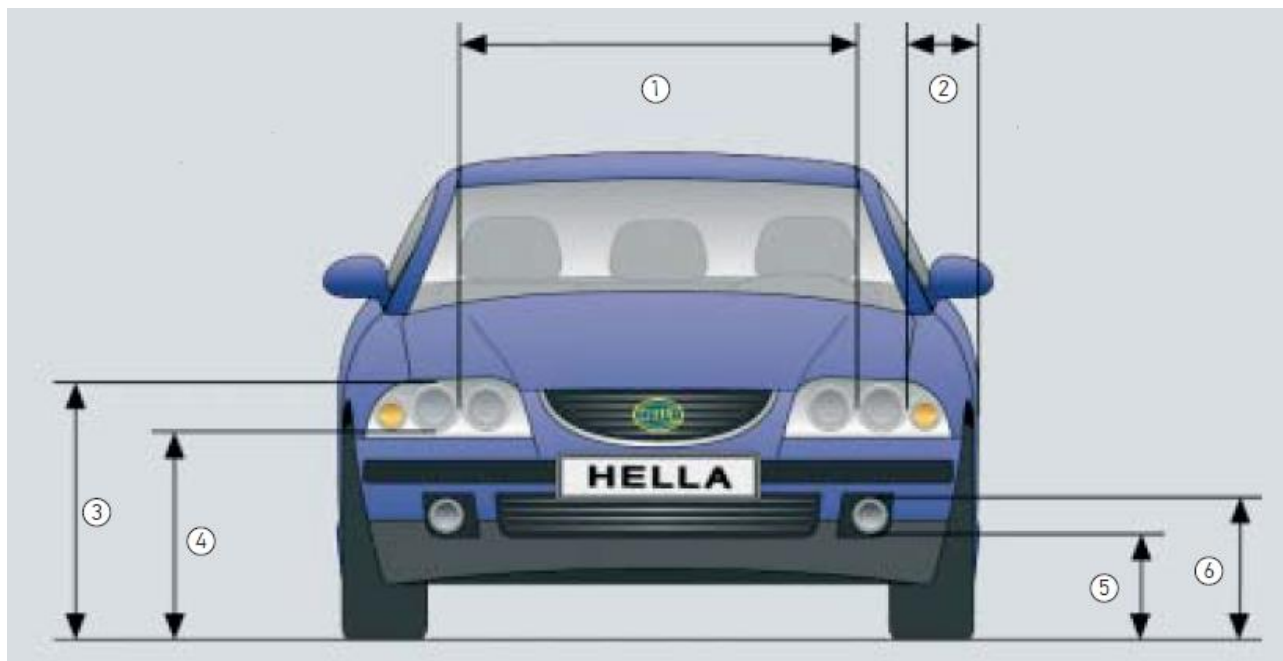
1.10 pav. Apšvietimo ir signalizacijos prietaisų montavimo automobilio priekyje schema [3]
