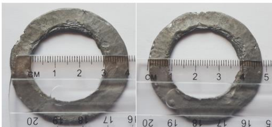
23 pav. 1,9mm storio švininės apsaugos vidinis skersmuo 3cm, o išorinis skersmuo 4,85cm
