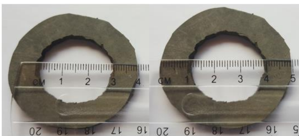
25 pav. 3,9mm storio švininės gumos vidinis skersmuo 3 cm, o išorinis skersmuo 4,95 cm
