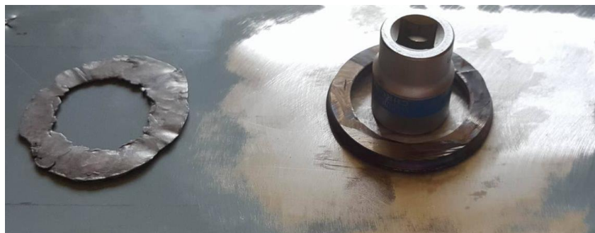
22 pav. Švino apskritimo su 3cm vidiniu diametru ir >4cm išoriniu diametru gamyba
