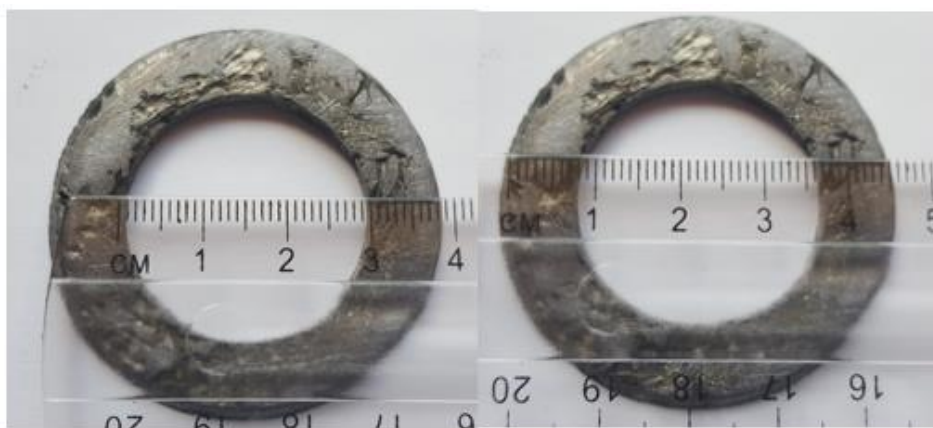
24 pav. 3,1mm storio švininės apsaugos vidinis skersmuo 3cm, o išorinis skersmuo 4,6 cm
