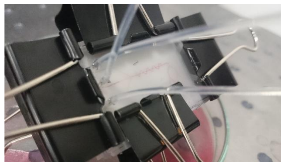
42 pav. Mikroskystinis prietaisas su prijungta skysčio manipuliavimo įranga
