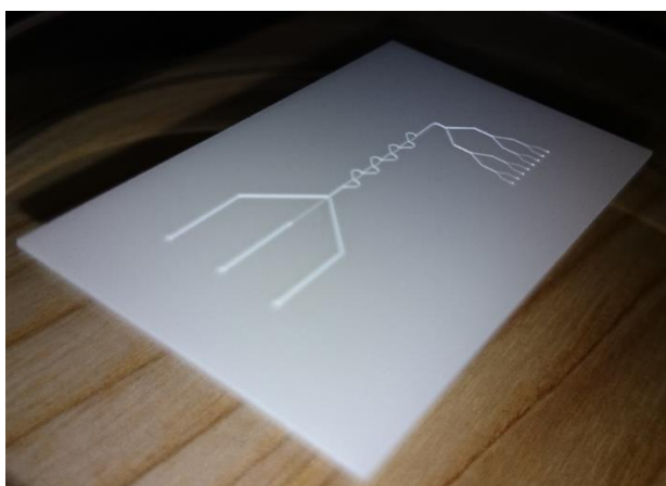
71 pav. Mikroskystinio prietaiso pagrindas, matmenys 4,5x3 cm
