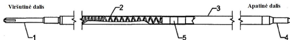
1.2 pav. GE14 kuro strypas. 1-viršutinis kaištis, 2-suspaudimo spyruoklė, 3-apvalkalo vamzdelis, 4-apatinis kaištis, 5-kuro tabletės [5].
