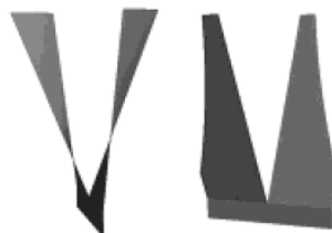
1.22 pav. Maišymo menčių modeliai. Kairėje - NJ tipo maišymo mentės (naudotos Xiang-Zhe CUI ir Kwang-Yong KIM tyrime); Dešinėje - SV tipo maišymo mentės [29].
