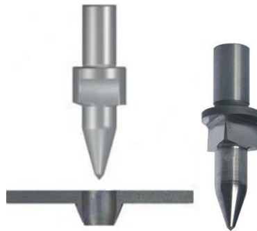
1.7 pav. Įrankio konstrukcija su nupjovimo briauna
