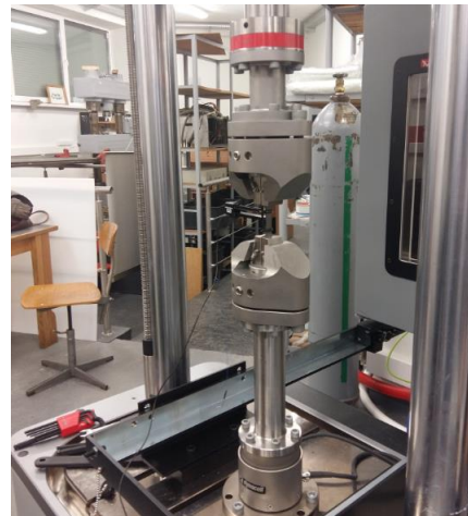
2.1 pav. Bandinio modelis su matmenimis ir bandinio vaizdas INSTRON bandymų mašinoje
