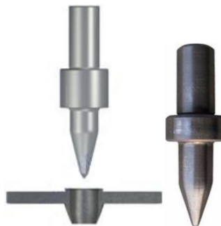
1.5 pav. Įrankio konstrukcija su užapvalinta briauna
