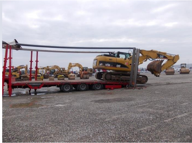
3.12 pav. Realios puspriekabės deformacijos, vaizdas iš šono
