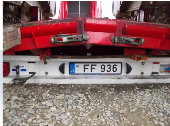
3.10 pav. Realios puspriekabės deformacijos, vaizdas iš galo
