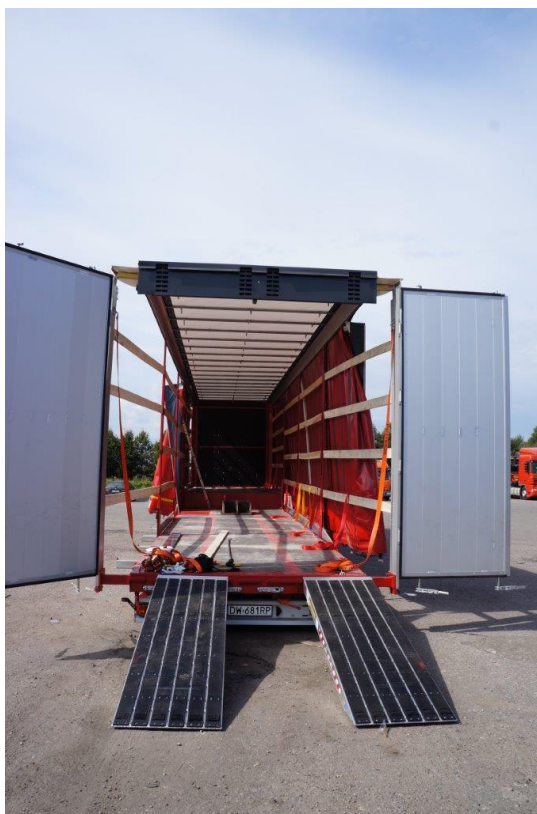
2.8 pav. Praplatinta ir išaukštinta puspriekabės pakrovimo dalis
