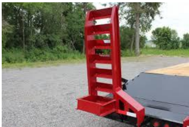
1.14 pav. Stacionarios rankiniu būdu kilnojamos rampos [8]
