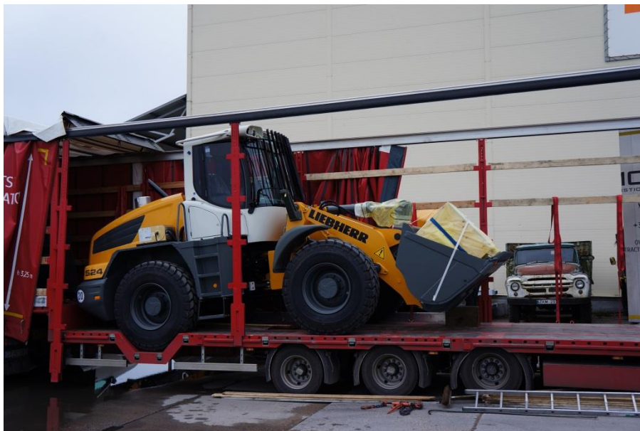
2.9 pav. Pakrauta savaeigė technika naudojant grindų išpjovą
