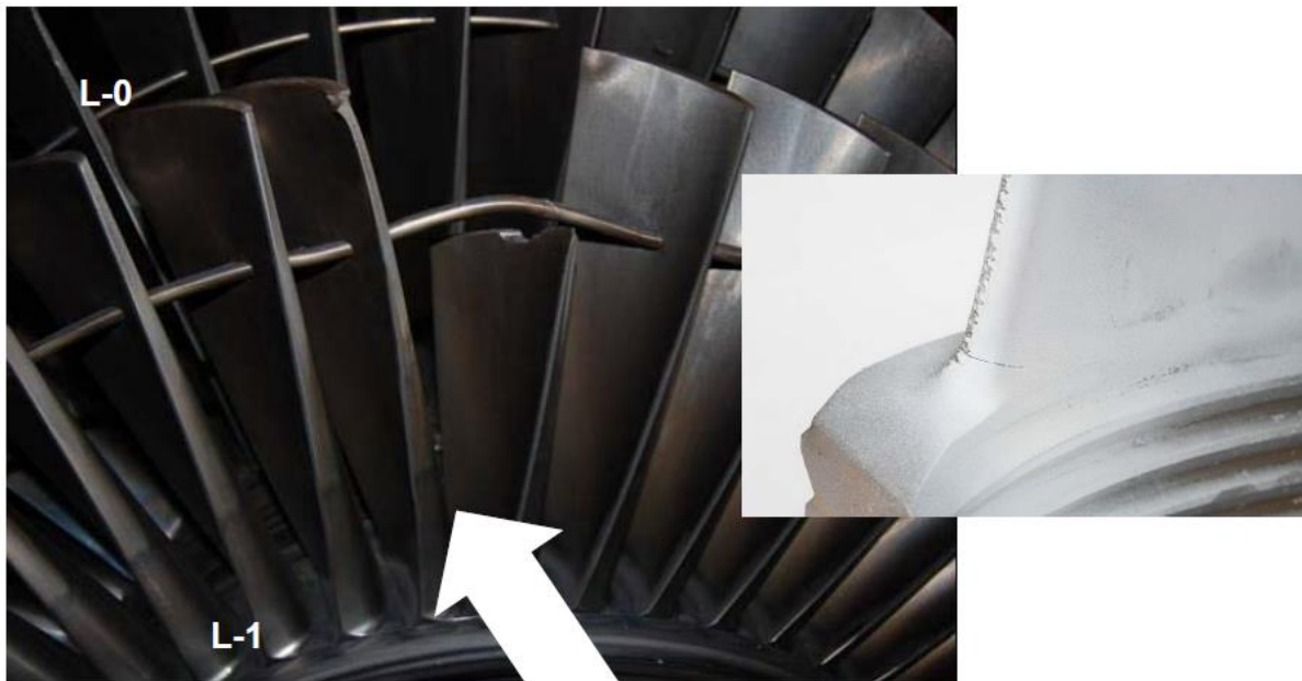
3-6 pav. Mentelių dilimas dirbant minimaliu, ribiniu apkrovimu
