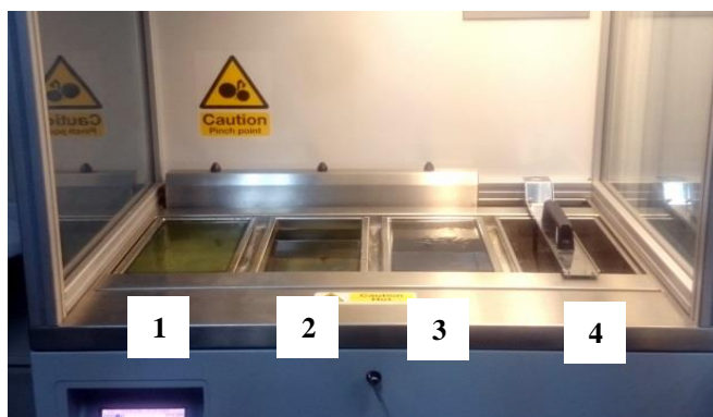
18 pav. Keturių sekcijų stiklų plovimo įrenginys– vonelėje nr.1 – šarminis tirpalas, 2 – vanduo, 3 – distiliuotas vanduo, 4 – džiovinimas IR spinduliais
