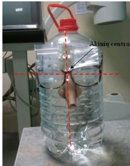
3.2.1 pav. Akinių centras – intervensinės radiologijos specialisto fantomo atskaitos taškas
