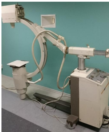
3.1.1 pav. Kilnojamas C – lanko medicinos rentgeno diagnostinis aparatas „Siremobil“
