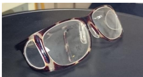
3.1.2 pav. Švinuoti apsauginiai akiniai su šonine švinuota apsauga, kurie buvo naudoti atliekant matavimus
