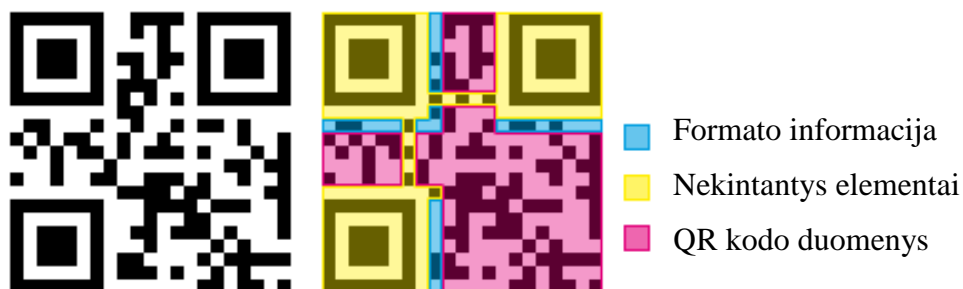
2.1 pav. QR kodo struktūra [38]
