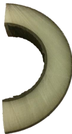
Pav. 1.13. XLPE izoliacija su laidininko ir izoliacijos ekranu.
