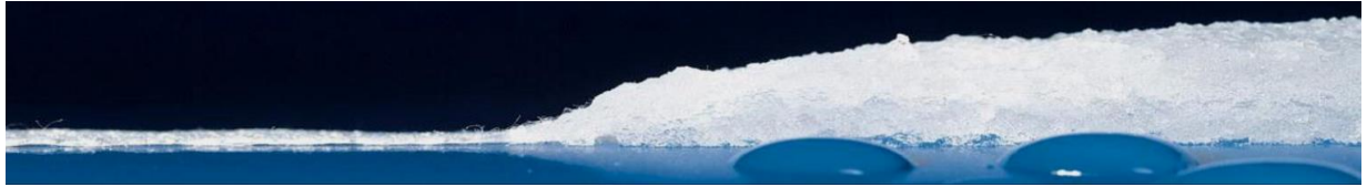
Pav 1. Išbrinkstanti juosta. Dešinėje aplieta vandeniu, kairėje sausa.
