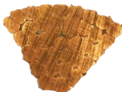
Pav. 1.11. Vienas Milliken segmentas su išbrinkstančiais siūlais viduje. [2]
