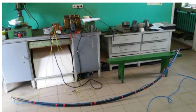
5 pav. Atliekami matavimai, laidininkas 16,0 \text{ mm}^2
