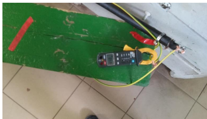
4 pav. Atliekami matavimai, laidininkas 6,0 \text{ mm}^2
