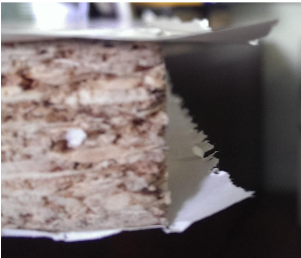
4 pav. Baldinės plokštės vaizdas iš šono, po plokštės atskyrimo
