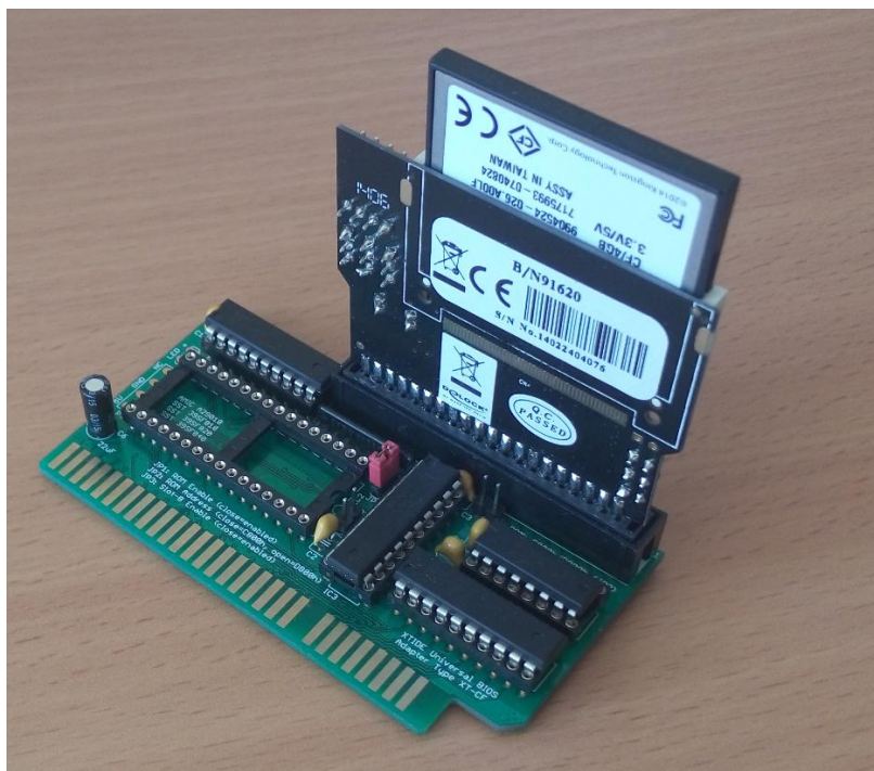
4.3 pav. Surinktas keitiklis su įstatyta atminties kortele
