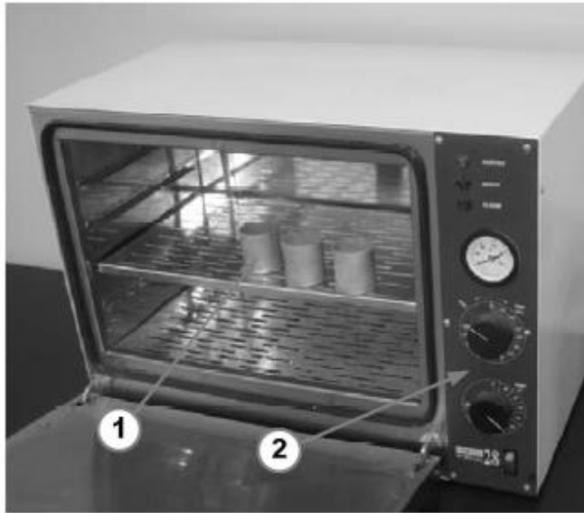
24pav. Naudota speciali gruntų džiovinimo krosnelė
