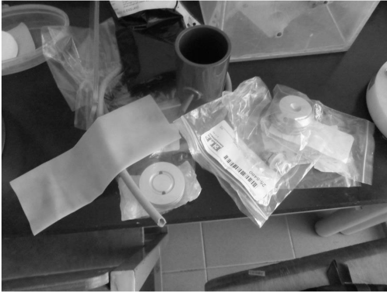
28.7 pav. Bandinio talpinimo membrana ir gniuždymo gnybtų kompleksas
