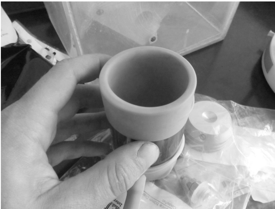
33pav. Naudojama bandinio talpinimo į guminę membraną įranga.
