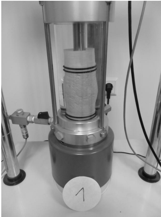
34 pav. Atliekamas bandinio Nr.1 triašis suspaudimas
