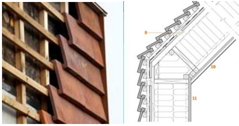
58. pav. fasadinių ir stogo čerpių konstrukcinė detalė
