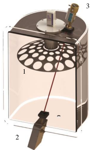
16 pav. Principinė optinio monitoringo schema: 1) kupolas; 2) detektorius; 3) šviesos šaltinis [27]
