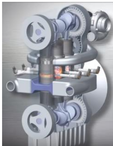
1.2.5.1 DDSCV su turbina ir tiesioginio kuro įpurškimo sistema [1]
