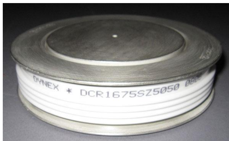
1.13 pav. HVDC sistemose naudojamas tiristorius
