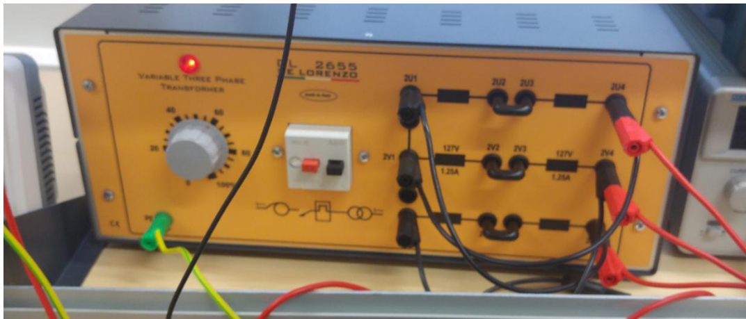
3.12 pav. Laboratorijoje naudojamas autotransformatorius
