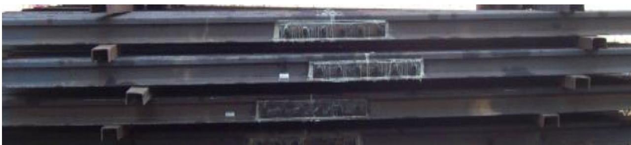
2.14 pav. Neišardoma izoliuotoji klijuotinė sandūra [51]
