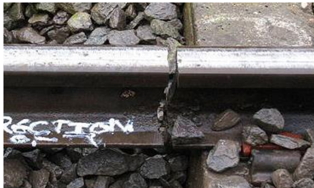
1.14 pav. Nutrūkęs bėgis (tarpas mažesnis nei 25 mm) [43]
