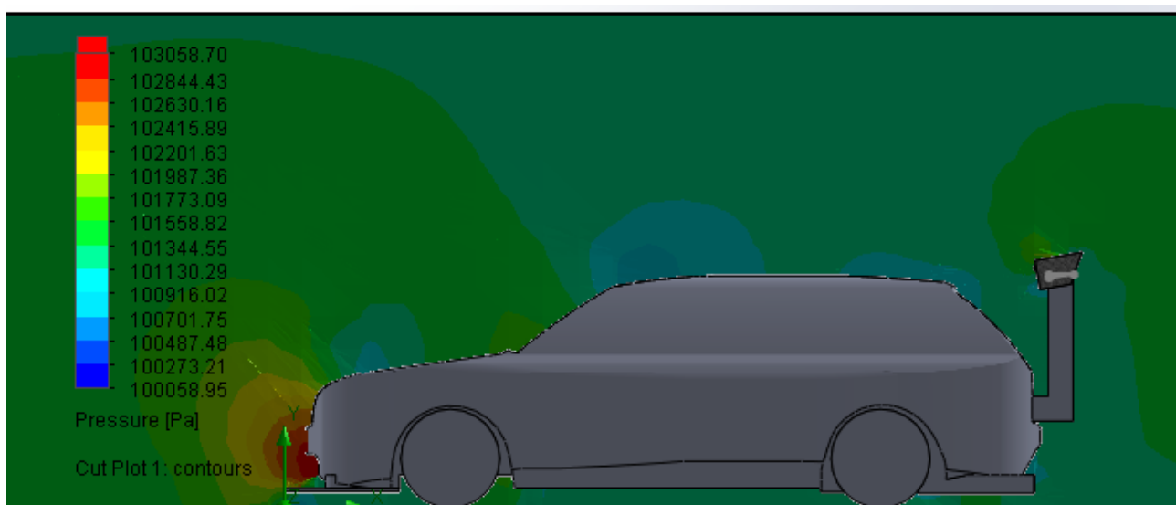
3.9 pav. Slėgio pasiskirstymas esant 120km/h greičiui, kai aktyvus antisparnas pritvirtintas 150 mm virš automobilio stogo linijos, 260 mm už automobilio galinės dalies ir atakos kampas nustatytas 10^\circ
