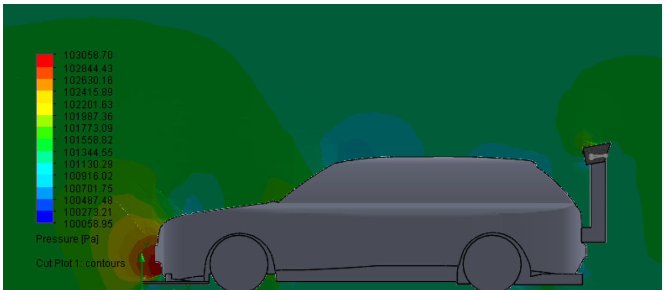
3.7 pav. Slėgio pasiskirstymas esant 180km/h greičiui, kai aktyvus antisparnas pritvirtintas 150 mm virš automobilio stogo linijos, 260 mm už automobilio galinės dalies ir atakos kampas nustatytas 10°
