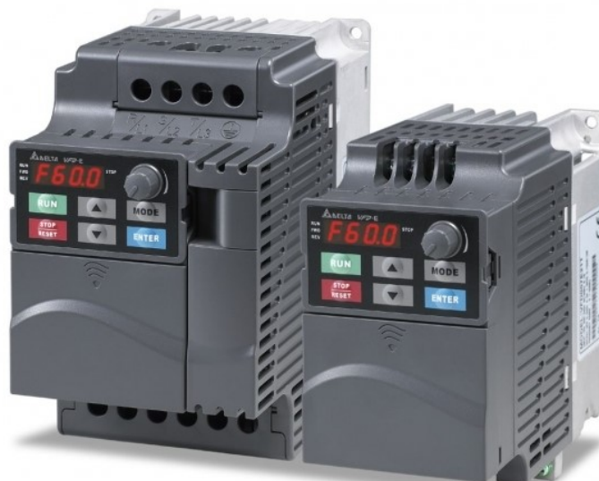
2.3.7 pav. Dažnio keitiklis. 22 kW, išėjimo dažnio diapazonas 0.1~600Hz, integruotos loginio valdiklio funkcijos, su galimybe vykdyti nesudėtingas programas, išėjimo srovė- 45A.[1]
