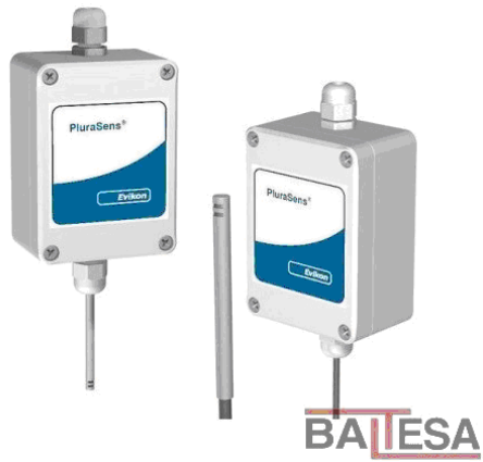
2.3.2 pav. Lauko temperatūros ir drēgmēs jutiklis. Matuojamas diapazonas: 0...100 %RH, -40...+120 °C. [8]
