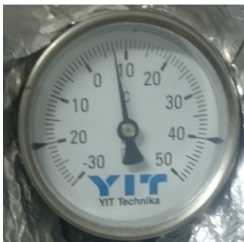
2.2.1 pav. Temperatūros indikatorius (-30....50°C)
