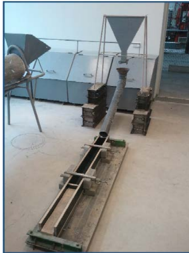
Pav. 10. Savaime susitankinančio betono liejimas į formą
