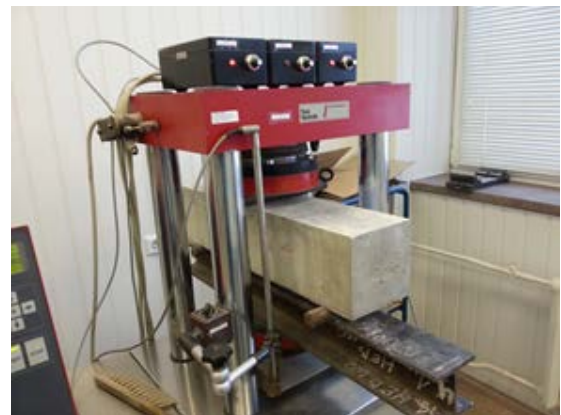
Pav. 11. Tritaškio lenkimo bandymo schema ir eksperimente naudotas hidraulinis presas „Toni Technik“
