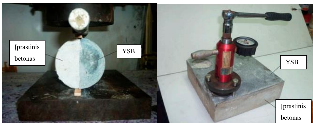
3.4 pav. Adhezijos matavimo būdai (kairėje cilindrinis tempimo bandymas, dešinėje atplėšimo bandymas [10])
