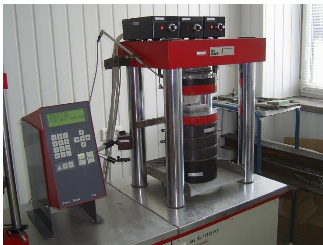
4.12 pav. Betono stiprio gniuždant nustatymo įranga
