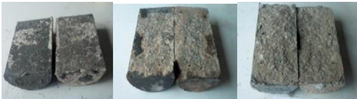
3.3 pav. betono suirimo tipai (kairėje- per sandūros paviršių, viduryje- dalinai pe sandūros vietą, dešinėje- per įprastinio betono paviršių) [25]
