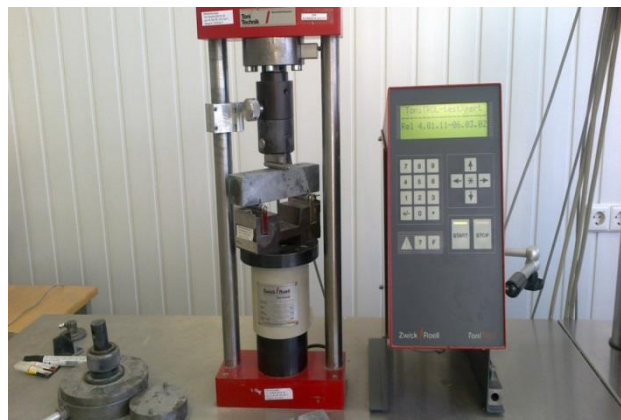
4.18 pav. Betono stiprio lenkiant nustatymo įranga
