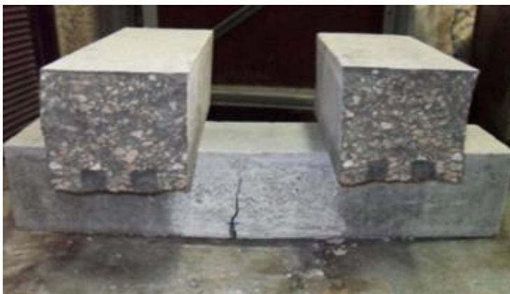
3.1 pav. Hibridinės sijos armuotos strypais iš YSB [1]
