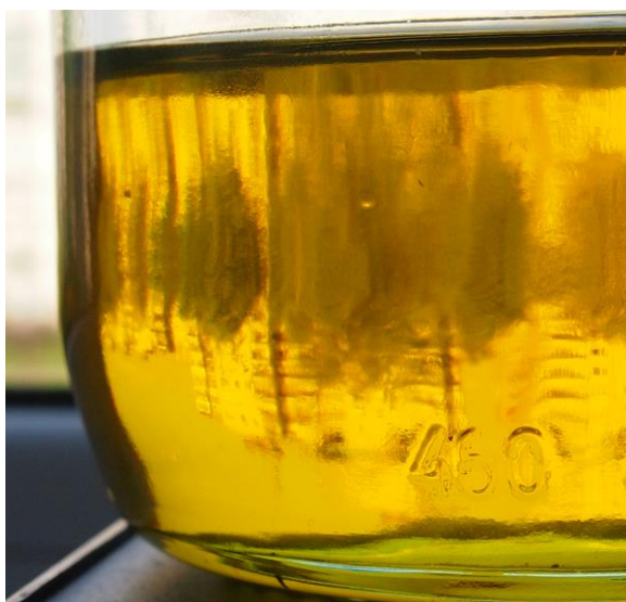
13 pav. Mišinio sluoksniavimosi tyrimas esant 1 °C aplinkos temperatūrai
