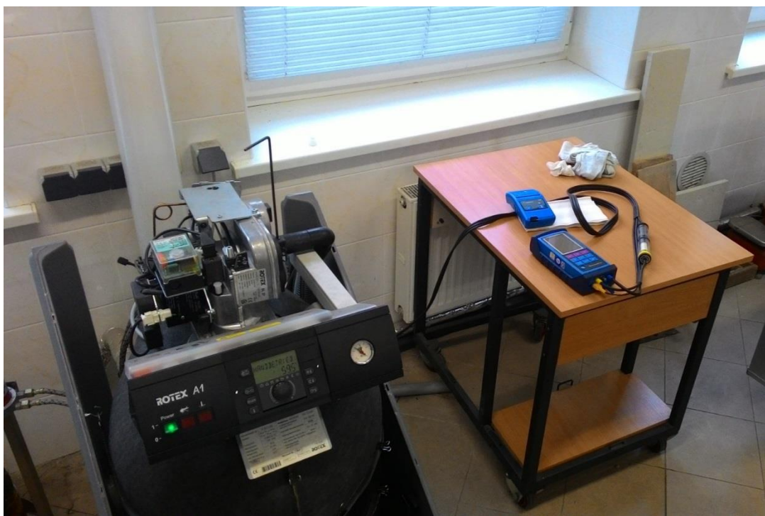
17 pav. Skystojo kuro katilas ir dūmų analizatorius
