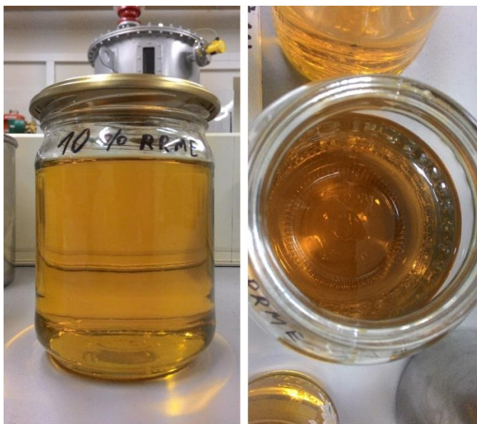
12 pav. Mišinio sluoksniavimosi tyrimas esant 15 °C aplinkos temperatūrai
