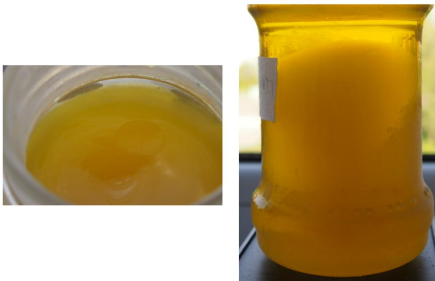
14 pav. Mišinio sluoksniavimosi tyrimas esant -18\text{ }^{\circ}\text{C} aplinkos temperatūrai
