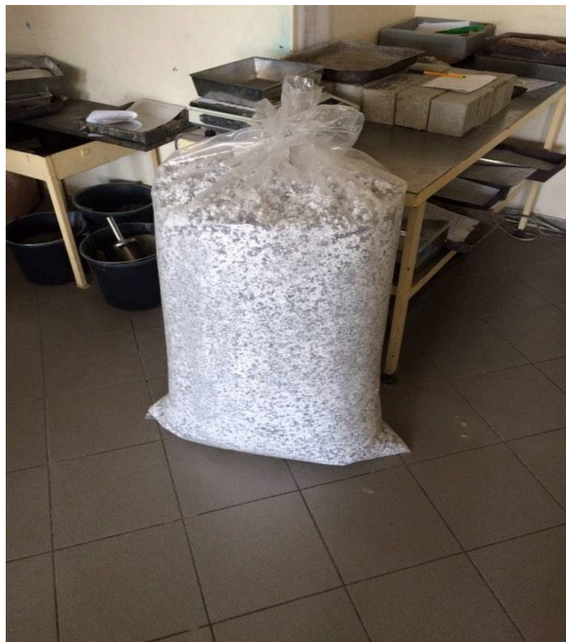
20 pav. Polistireninio putplaščio granulės, dalelių tankis 30 \text{ kg/m}^3
