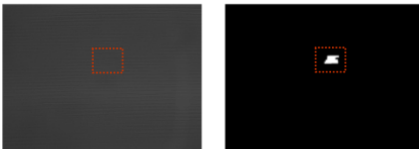
4 Pav. Defektų poliarizatoriuje aptikimas taikant nesudėtingą morfologinę vaizdo analizę [36].
