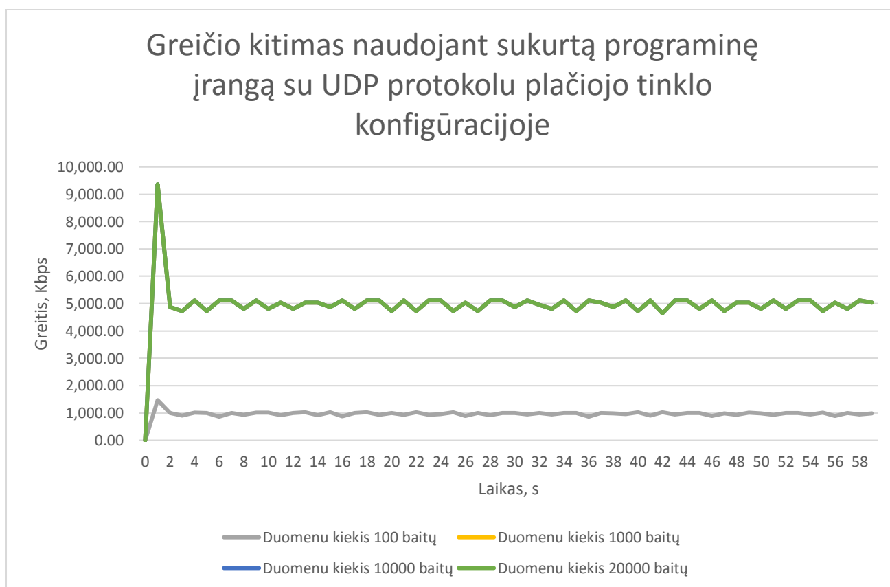
56 pav. Greičio kitimas naudojant sukurtą programinę įrangą su UDP protokolu plačiojo tinklo konfigūracijoje
