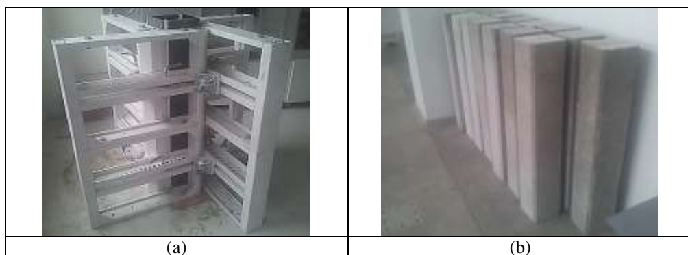
2.2 pav. Klojinių sistema bandiniams formuoti (a) ir suformuotų betono bandinių prizmės (b)
