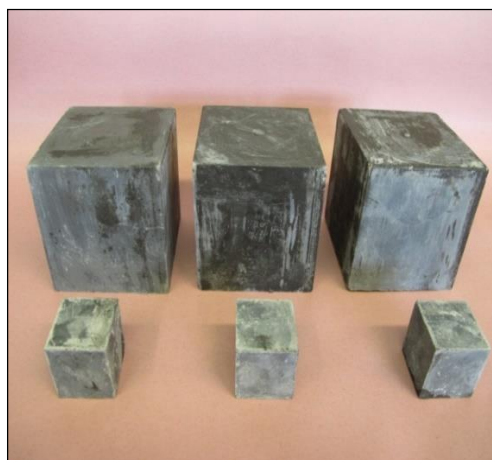
4.17 pav. Mastelio faktoriaus dydžio įtaka ypač stipraus betono gniuždymo stipriui
