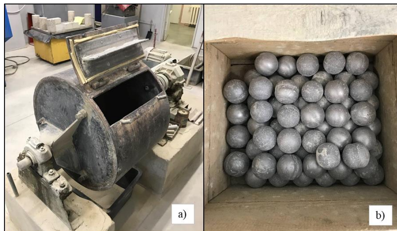
Fig. 26. Lab ball mill: a) Drum b) Metal balls
