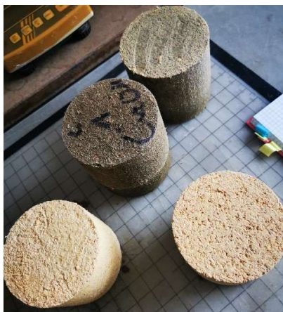
24 pav. Bandiniai po vandens įgeriamumo bandymo
