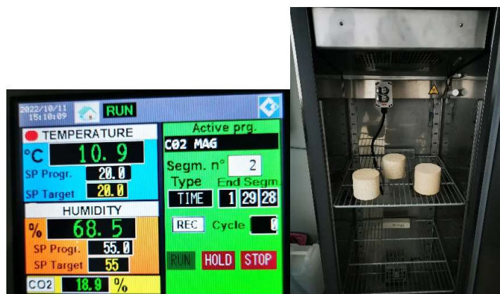
18 pav. Bandinių kietinimo sąlygos CO 2 kameroje
