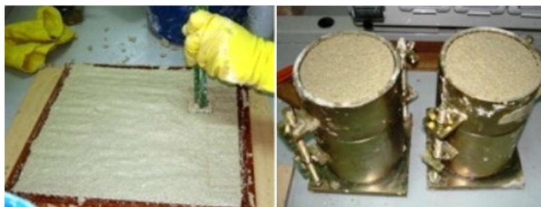
11 pav. Kanapių biokompozito gamybai naudota stačiakampio gretasienio( dešinėje) ir cilindro (kairėje) formos [4]
