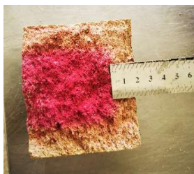
21 pav. Ant perskelto bandinio užpurškštas fenolftaleino indikatorius ir išmatuotas karbonizacijos gylis
