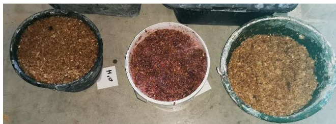
15 pav. Pamerktos pjuvenos: kairėje tik su vandeniu, viduryje su \text{Ca}(\text{OH})_2 milteliais, dešinėje su \text{CaCl}_2 granulėmis
