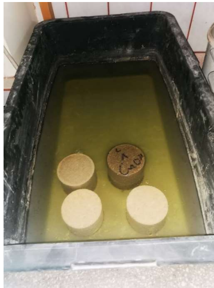
23 pav. Biokompozitų vandens įgeriamumo bandymas
