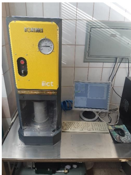
24 pav. Giratorius naudojamas betoninių bandinių gamybai
