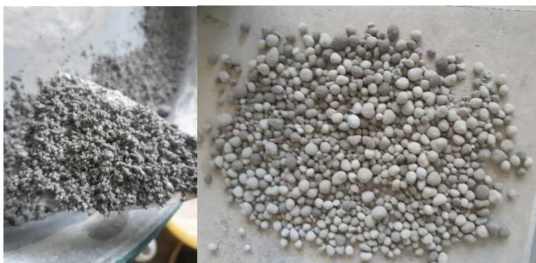
17 pav. Vandens tiekimas vien dulksna (kairėje), vandens tiekimas lašeliais ir dulksna (dešinė)
