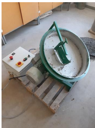
16 pav. Granulatorius naudojamas dirbtiniams užpildams gaminti
