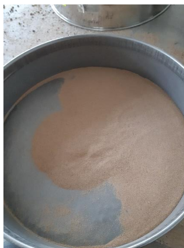
15 pav. Išsijotas smėlis granuliavimo bandymams
