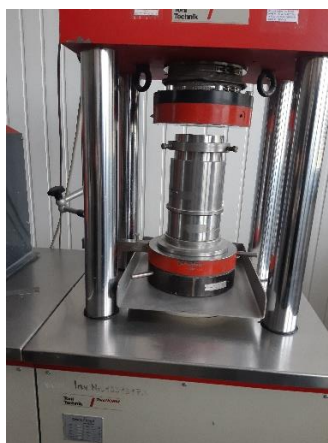
23 pav. Skalumo bandymui naudojamas presas
