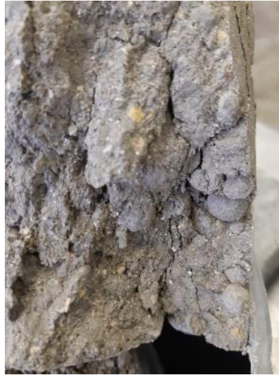
37 pav. Cementinių užpildų bandinio suirimas
