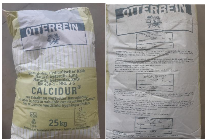
14 pav. Kalkės naudotos tiriamojoje dalyje OTTERBEIN gamtinės hidraulinės kalkės NHL 3,5
