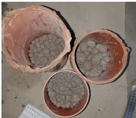
25 pav. Vandeniui laidaus betono gamyba
