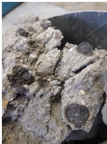
36 pav. Keramzitinių užpildų bandinio suirimas
