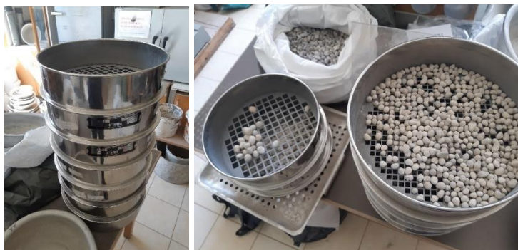
19 pav. Sijavimui naudojami sietai iki 16 mm skersmens užpildams
