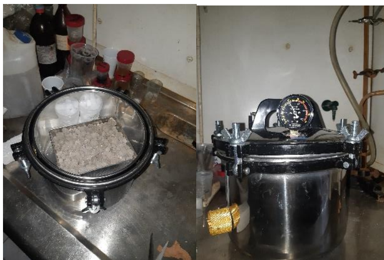
20 pav. Slėginis indas naudojamas karbonizacijai
