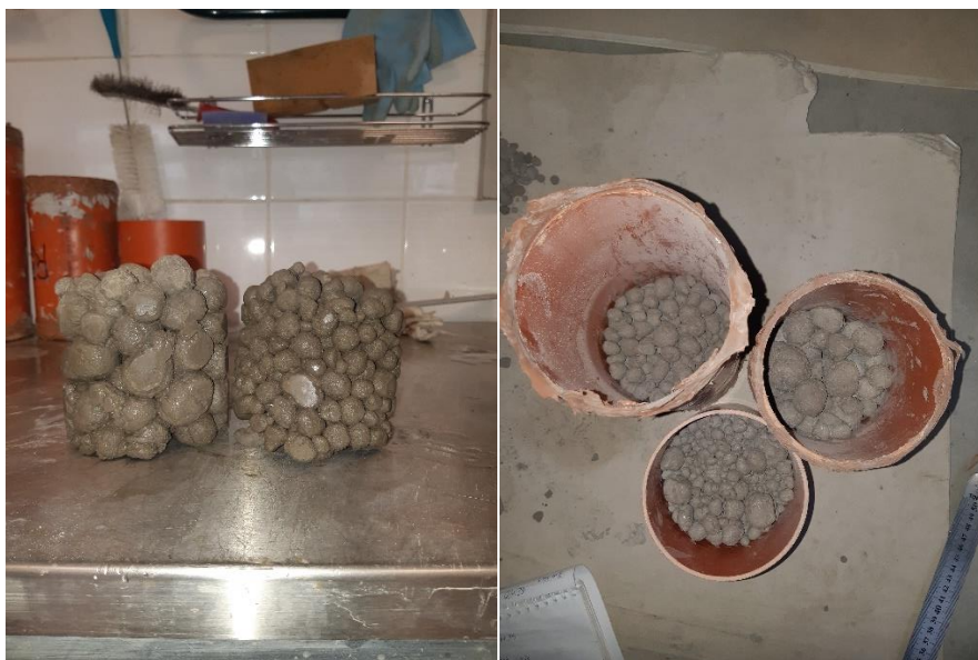
39 pav. Vandeniui laidūs gaminiai ir jų formavimas
