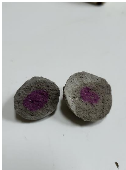
38 pav. Cementinių užpildų (kairėje) ir kalkinių užpildų (dešinėje) karbonizacijos gylio nustatymas naudojant fenolftaleiną.
