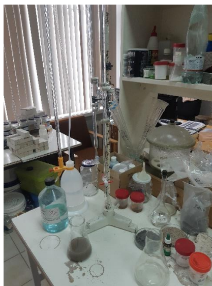
22 pav. Biuretė naudojama druskos rūgšties titravimui
