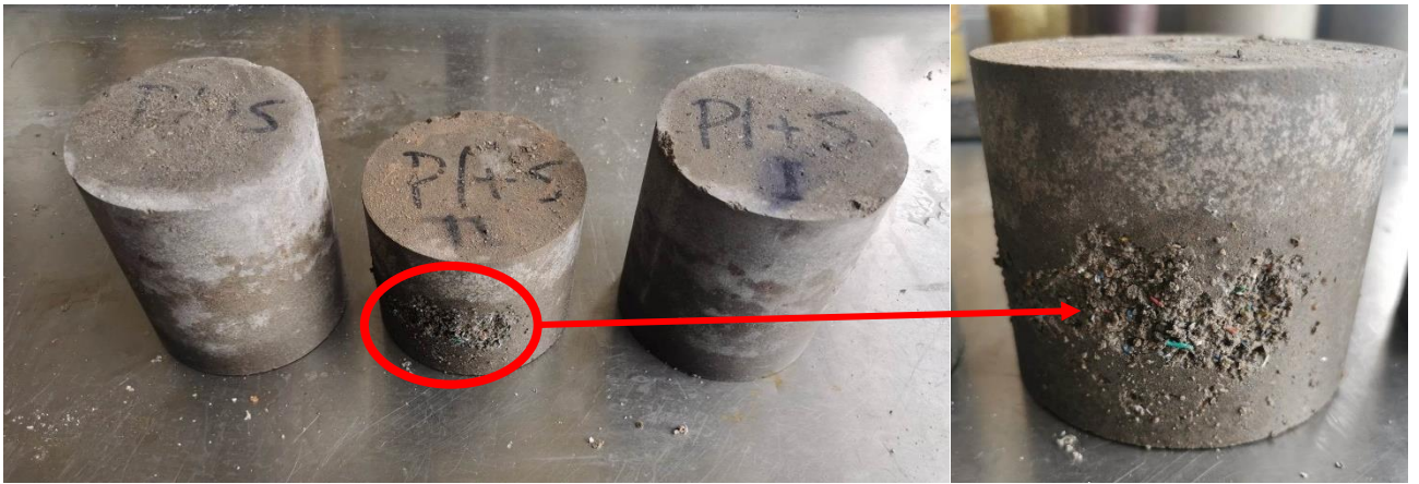
46 pav. Bandiniai St34P110, po 90 ciklų.
