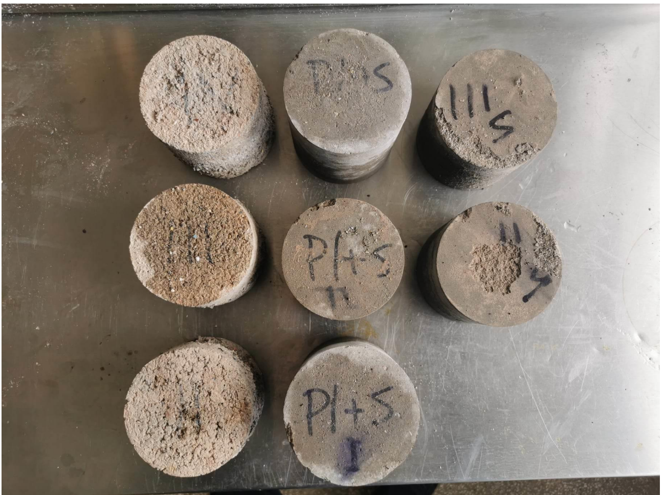
47 pav. Betoniniai bandiniai po 90 šildymo/šaldymo ciklų.
