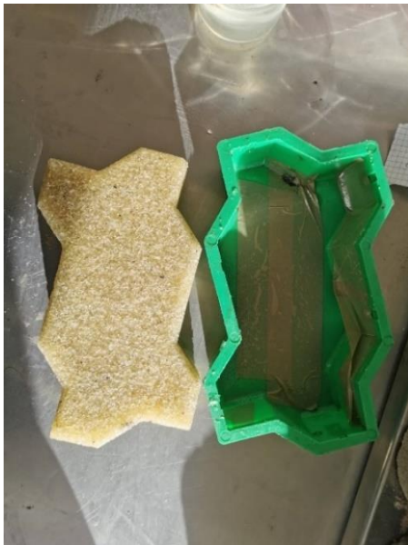
20 pav. Trinkelė padaryta naudojant smulkaus stiklo duženas.
