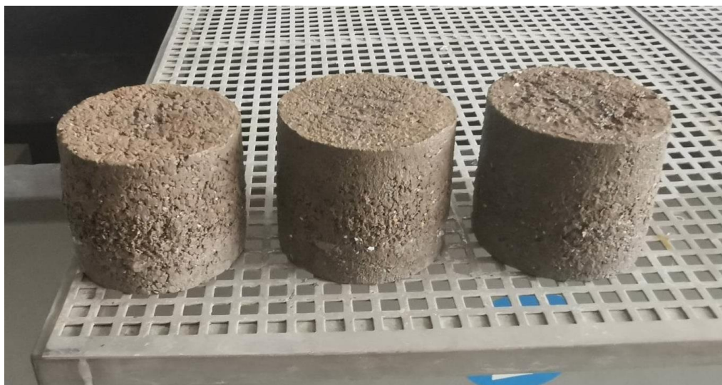
43 pav. Betoniniai su plastiku po 21 ciklo.
