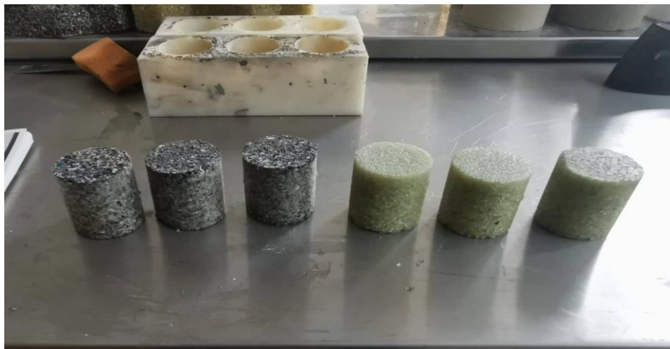
21 pav. Plastiko ir smulkiu stiklo duženų bandiniai.
