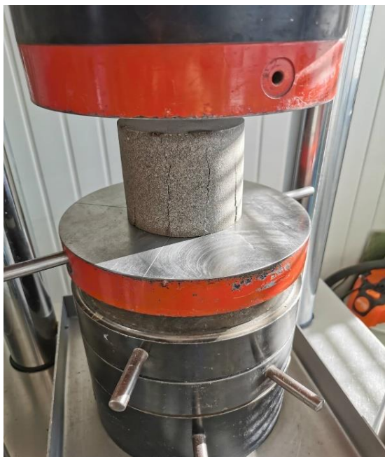
22 pav. Betoninio bandinio atsparumo gniuždymui nustatymas.
