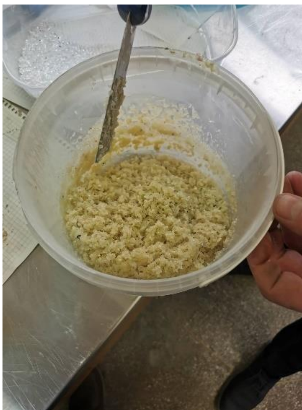
18 pav. Smulkių stiklo duženų ir polimerinių klijų mišinys.
