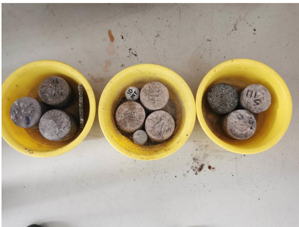
42 pav. Bandiniai paruošti šildymo/šaldymo bandymui.
