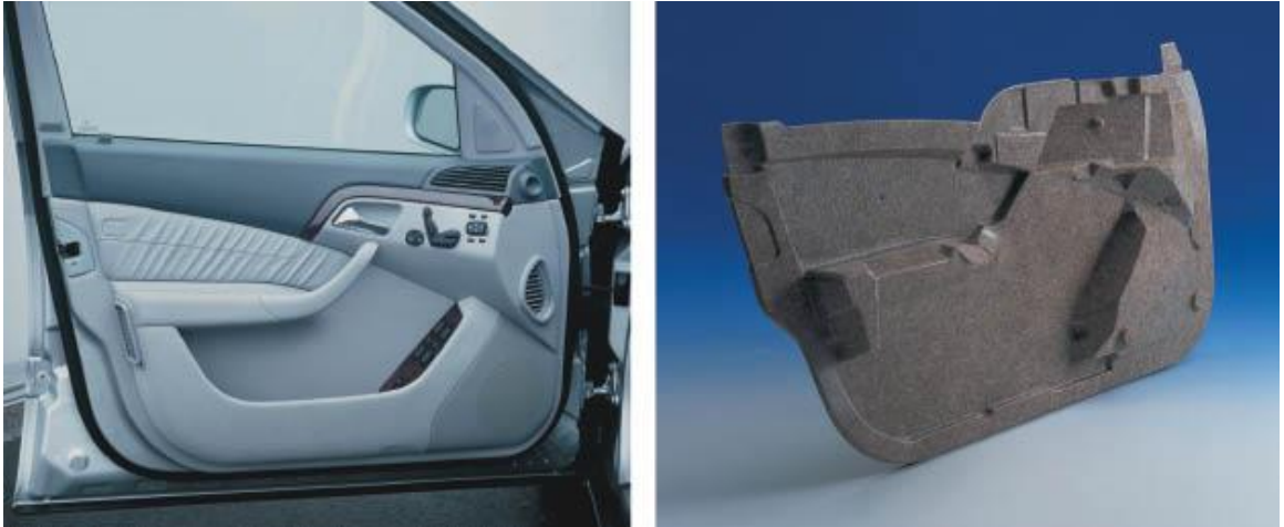
9 pav. Moderni vidinė durų apdailos plokštė, suformuota naudojant 60 % natūralaus pluošto kilimėlius ir „Baypreg“ poliuretano dervą [23]
