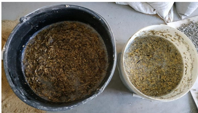
25 pav. Kanapių spalių pluošto apdorojimas mirkant vandenyje (kairėje) ir gesintų kalkių tirpale (dešinėje)
