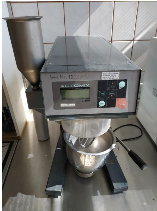
20 pav. 3 litrų skiedinio maišyklė „Automix 65-L0006A“
