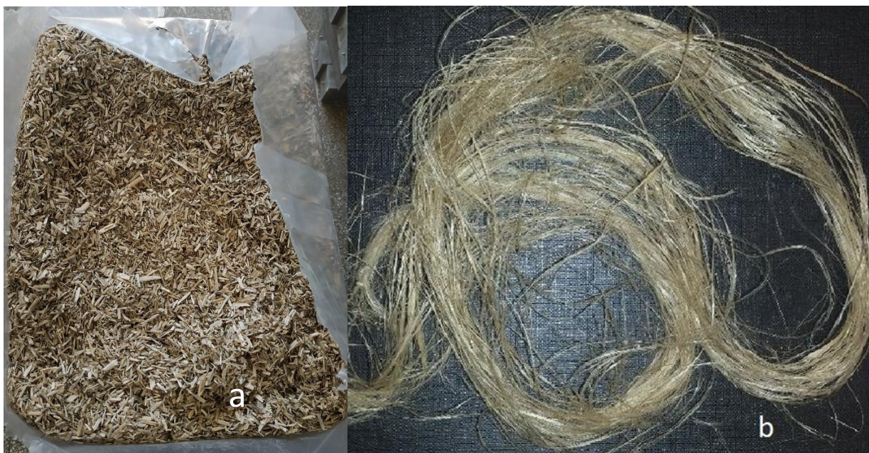
6 pav. Kanapių spaljai (a) ir kanapių pluoštas (b) [42]
