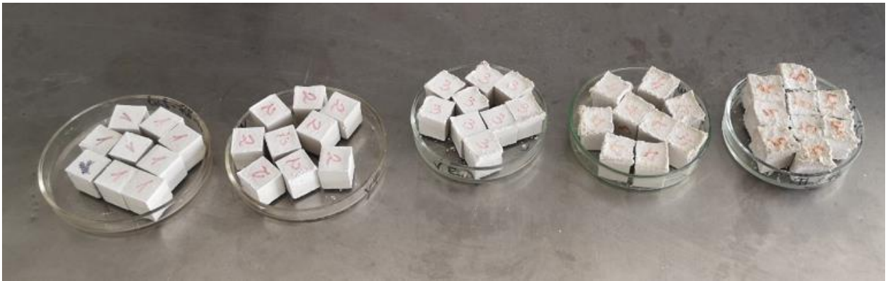
15 pav. Gipso bandiniai su \text{Na}_2\text{SO}_4 priedu
