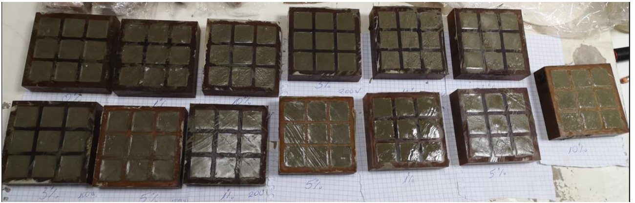
18 pav. Cementinio akmens bandinių su kalčio hidroksido priedu nuotrauka
