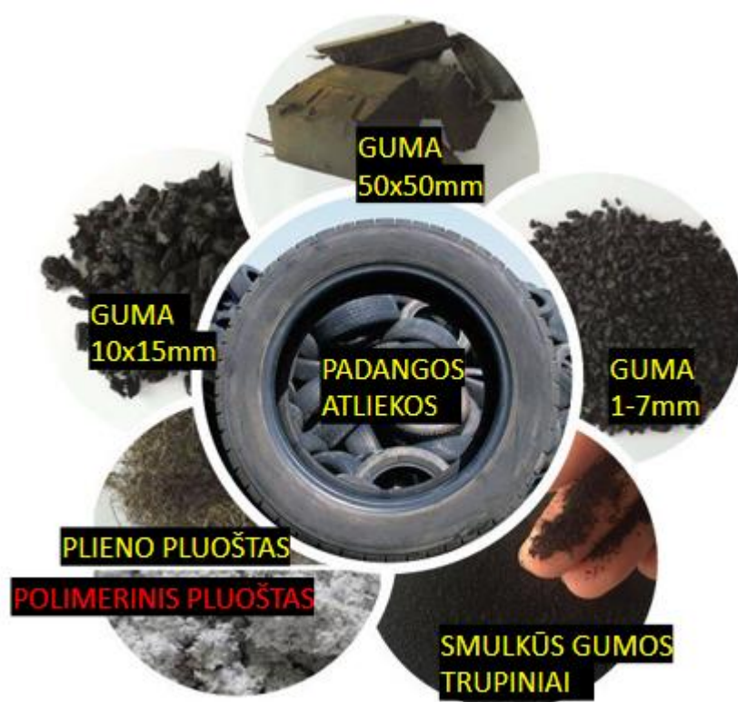
1 pav. Gaunami produktai perdirbus padangas
