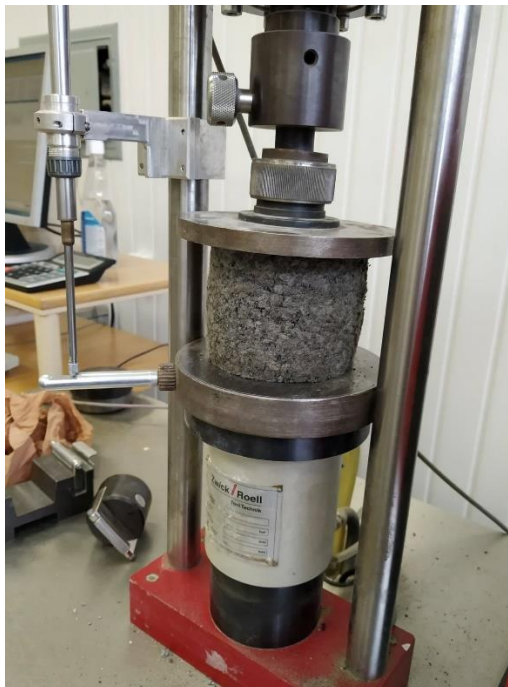
8 pav. Bandinio stiprumo nustatymo su presu ir deformacijų matuokliu proceso nuotrauka
