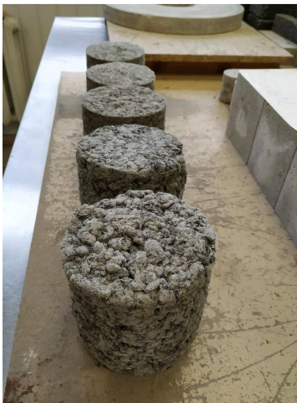
7 pav. Suformuotų padangų polimerinio pluošto ir įprastinio portlandcemenčio kompozitinių bandinių nuotrauka
