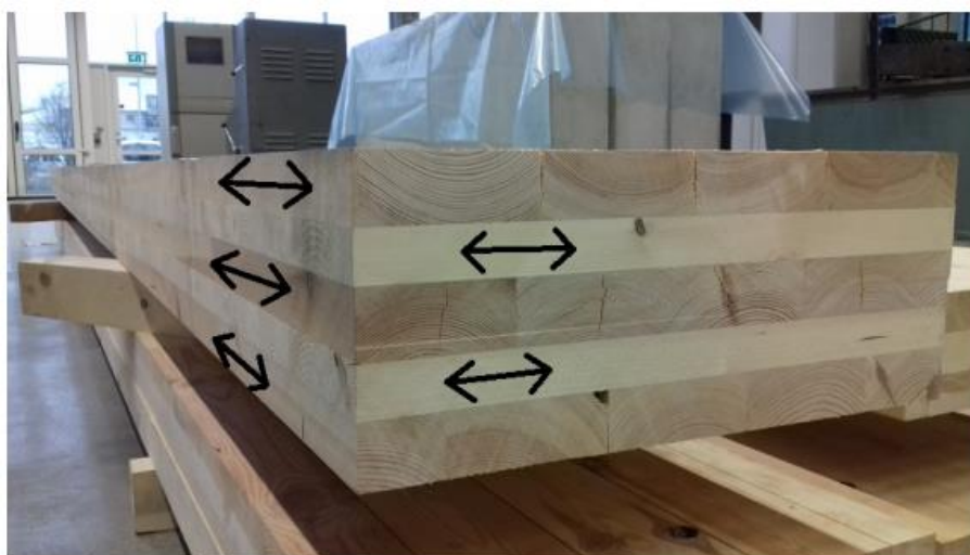
5 pav. CLT plokštės sluoksnių veikimo kryptys
