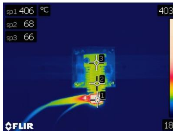
33 pav. Termovizoriaus rodmenys „Pronterface“ programoje pasiekus 450°C temperatūra
