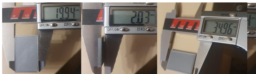
60 pav. Atspausdinto bandinio iš PLA matavimas
