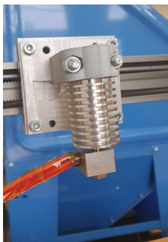
24 pav. Creality 3D CR-10/CR-10S kaitinimo elementas ir termistorius surinkta kaitinimo bloke
