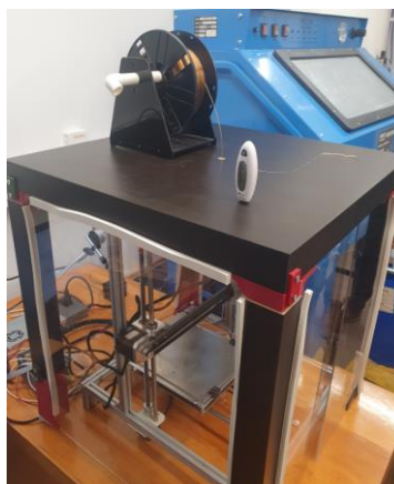
61 pav. Pilnai surinktas spausdintuvas su gaubtu paruoštas PEI spausdinimui
