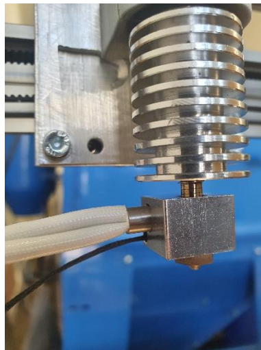
27 pav. Surinktas Mosquito® 12V 50W Heater kaitinimo elementas kaitinimo bloke
