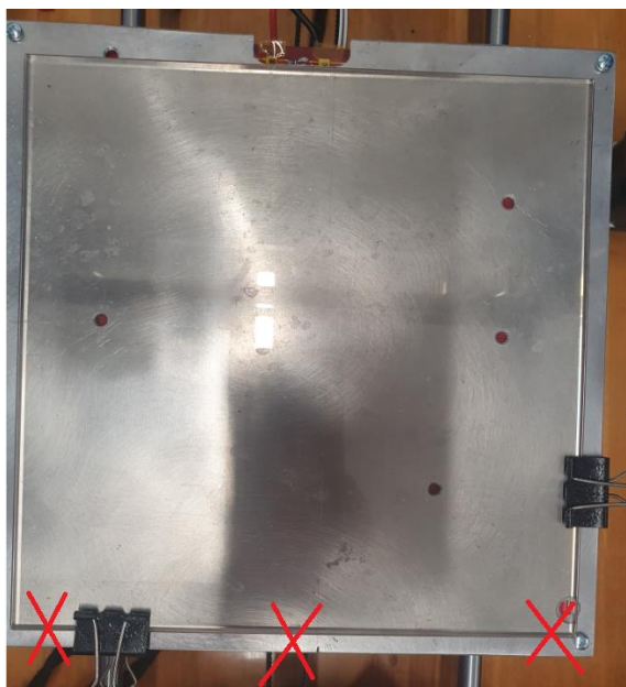
51 pav. Y ašies mechaninio matavimo sensoriaus tvirtinimo vietos pažymėtos raudonais x simboliais
