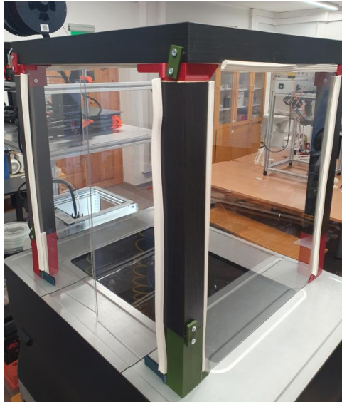
57 pav. Pilnai surinkta gaubto konstrukcija
