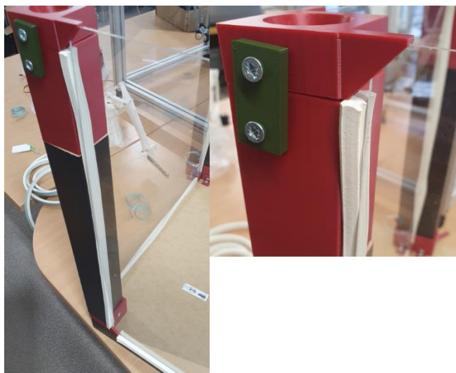
56 pav. Izoliacinės medžiagos ir stiklo įstatymas į konstrukciją
