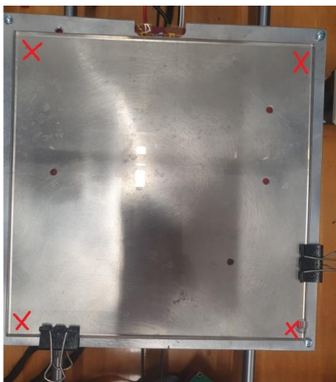
41 pav. Kaitinimo platformos kalibravimo taškai
