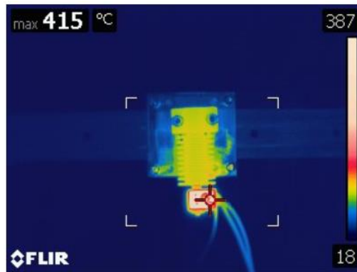
34 pav. Termovizoriaus rodmenys „Pronterface“ programoje pasiekus 450°C temperatūra ir kaitinimo bloką pasukus, kad būtų matomas tiesiogiai kaitinimo elemento galas
