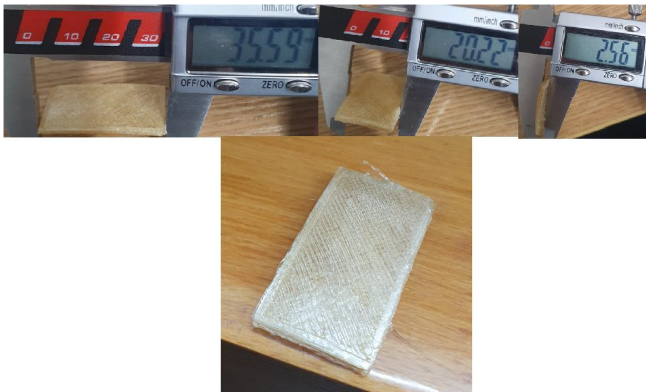
63 pav. Atspausdinta PEI detalė ir išmatuoti jos matmenys
