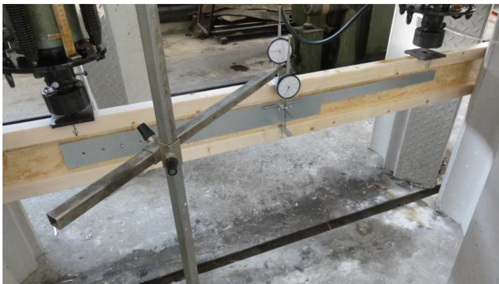
5 pav. Dvitėjės sijos laboratorinis bandymas (Lokaj & Klajmonová, 2017, p. 272)
