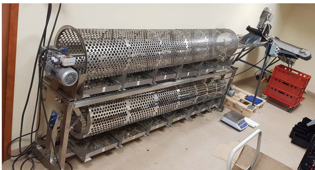
34 pav. Realus monetų rūšiavimo įrangos išdėstymas
