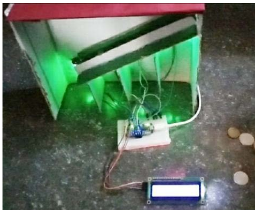
7 pav. Monetų rūšiavimo ir skaičiavimo įrenginys [12]
