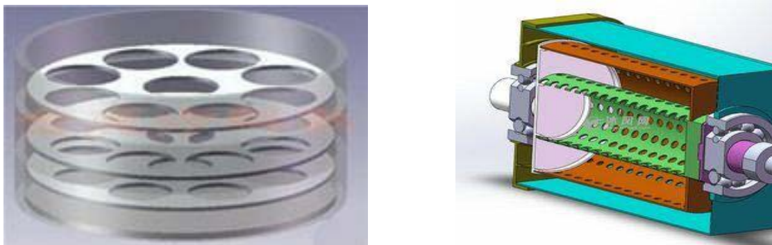
3 pav. Vibracinis (kairėje) ir išcentrinis (dešinėje) monetų rūšiavimo įrenginiai [8]
