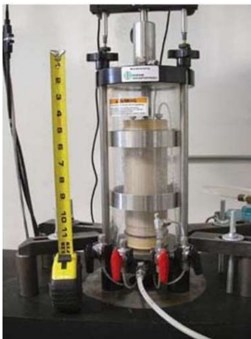
9 pav. Atsistatymo modulio ( M_r ) nustatymas laboratorijos sąlygomis [29]
