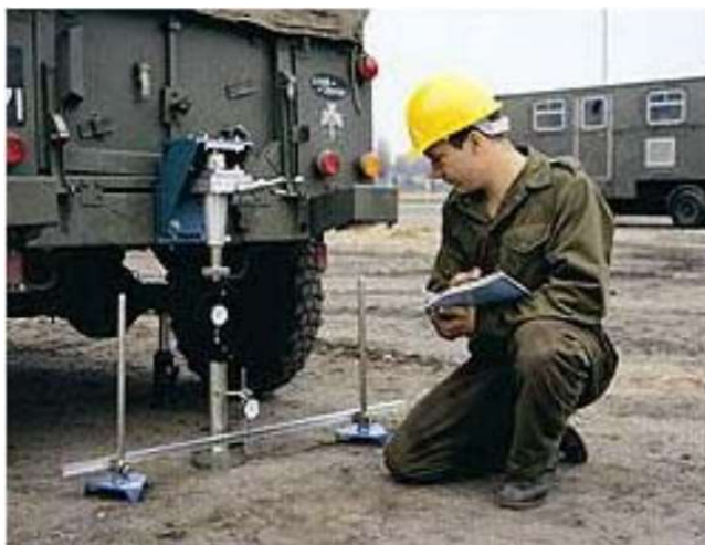
8 pav. Laikomiosios gebos Kalifornijos rodiklio nustatymas žemės sankasos įrengimo vietoje [18]
