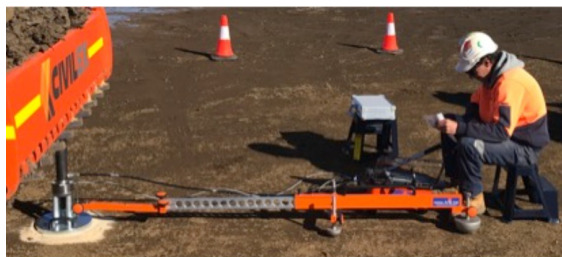
a) žemės sankasos laikomosios galios vertinimas atliekant plokščių statinės apkrovos bandymą
