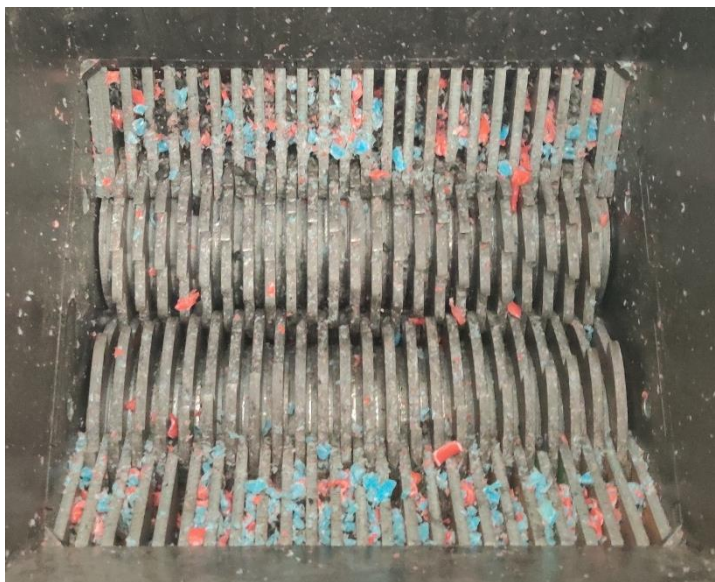
38 pav. Nežinomos kilmės plastiko likučiai tarp smulkinimo peilių
