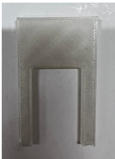
21 pav. Pagalbinė detalė tempimo bandinių pozicionavimui testavimo mašinoje
