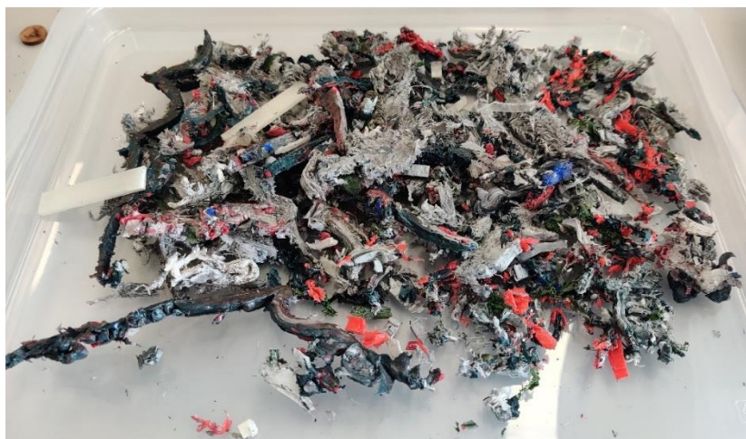
25 pav. Į didesniu segmentus susilydžiusios plastikos detalės
