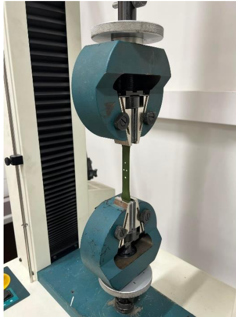
17 pav. Principinė tempimo bandymo schema
