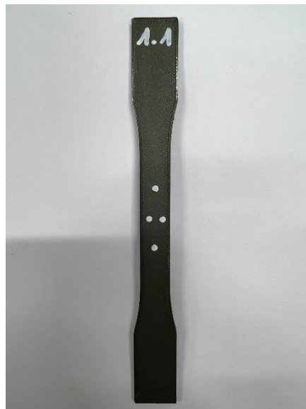
18 pav. Taškai bandinio centrinėje dalyje deformacijų matavimui
