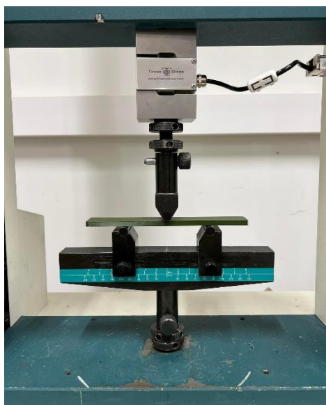
22 pav. Principinė lenkimo schema
