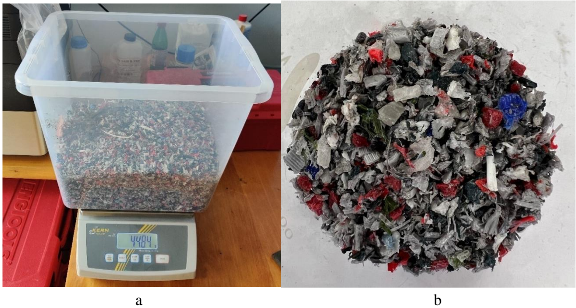
27 pav. Dėžės su PLA atliekomis po smulkinimo masė ir galutinis plastiko dalelių dydis
