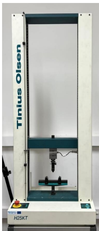
14 pav. „Tinius Olsen H25KT” universali testavimo mašina
