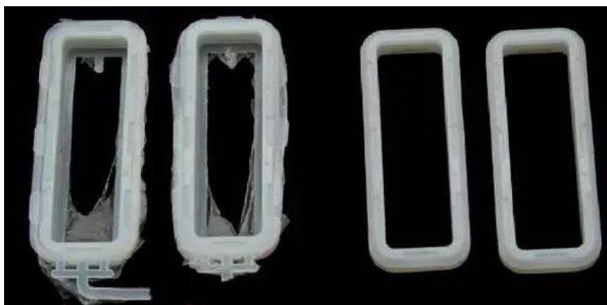
3 pav. Išlajos: dvi detalės su išlajomis (kairėje) ir dvi be išlajų (dešinėje)[5i]
