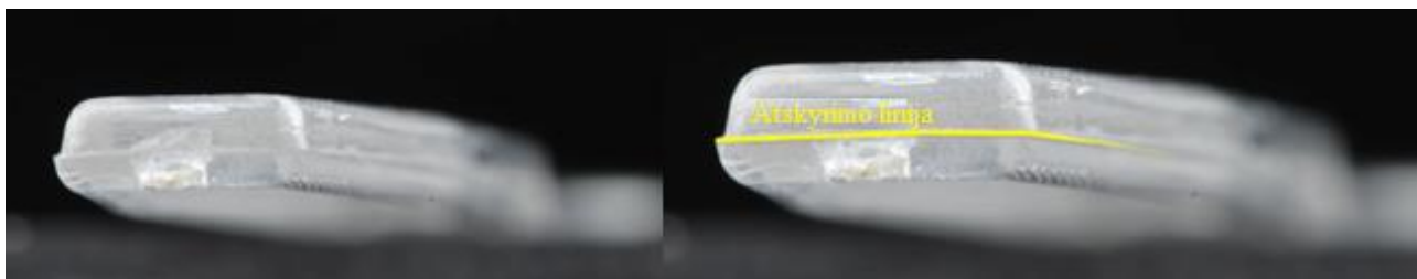
5 pav. Atskyrimo linijos ant detalių [6i]
