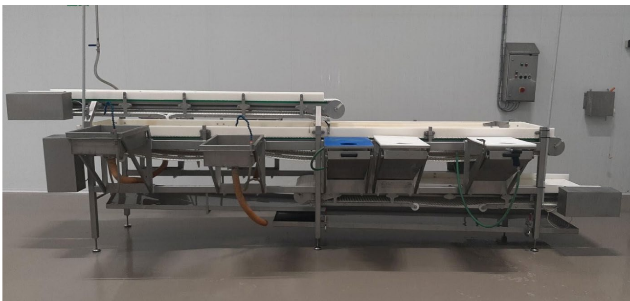
36 pav. Žuvies skrodimo ir plovimo trijų aukštų transporteris
