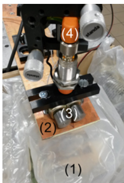
9 pav. Vibrovarikliai (3) ant sijos (2) su slopinimo elementu (1) ir poslinkio jutikliu (4)
