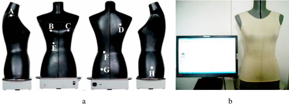
1.3 pav. „Išmanusis“ manekenas su 8-iais jutikliais manekeno antropometriniuose taškuose (a); eksperimento darbo vieta (b); A – dešiniojo peties jutiklis; B – krūtinės dešinės pusės jutiklis; C – krūtinės kairės pusės jutiklis; D – nugaros dešinės pusės jutiklis; E – šonkaulių dešinės pusės jutiklis; F – liemens kairės pusės jutiklis; G – klubų kairės pusės jutiklis; H – kairiojo klubo šoninės pusės jutiklis (Wang et al., 2011)
