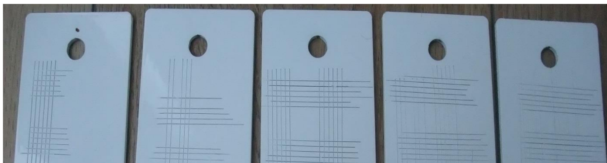
3.2 pav. Adhezijos tinklelinių įpjovų būdu galutiniai vaizdai
