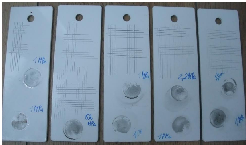
3.3 pav. Sukibimo stiprio matavimo galutinis vaizdas
