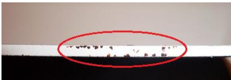
3.16 pav. Atsiradusios taškinės dėmės ant plokštelės briaunos po panardinimo į 70 proc. maistinę acto rūgštį.
