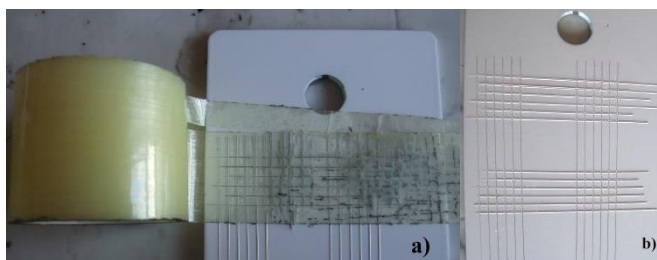
2.12 pav. Adhezijos klasifikacijos nustatymas: a) – lipnios juostelės klijavimas kryžminių įpjovų plote, b) – galutinis vaizdas po bandymo
