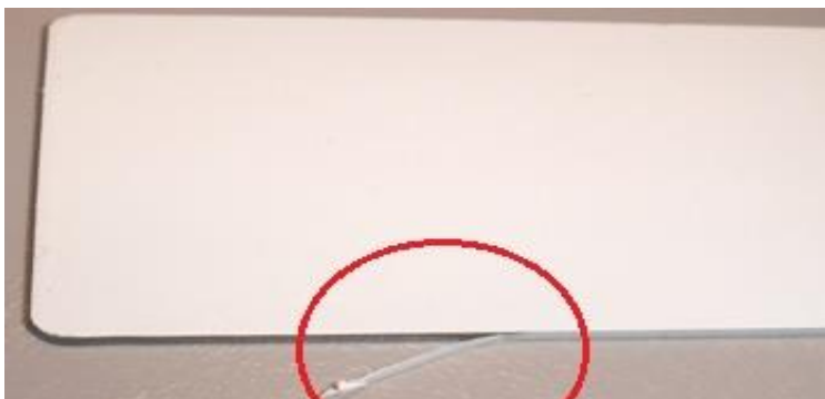
3.14 pav. Rūgštinio koncentruoto valiklio poveikis polimerinei dangai
