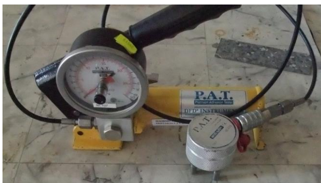
2.13 pav. Sukibimo stiprio matavimo prietaisas P.A.T. GM 01
