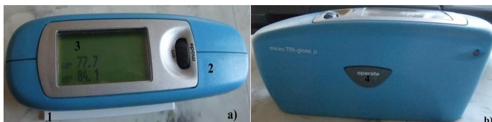
2.9 pav. Blizgumo matavimo prietaisas: a) vaizdas iš viršaus: 1 – bandinys, 2 – matavimo prietaisas, 3 – duomenų ekranas; b) vaizdas iš šono: 4 – „operate“ mygtukas
