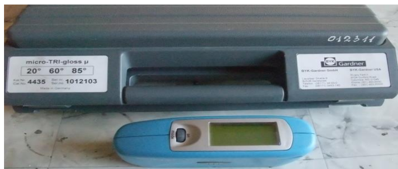
2.8 pav. Blizgumo matavimo prietaisas micro-TRI-gloss \mu
