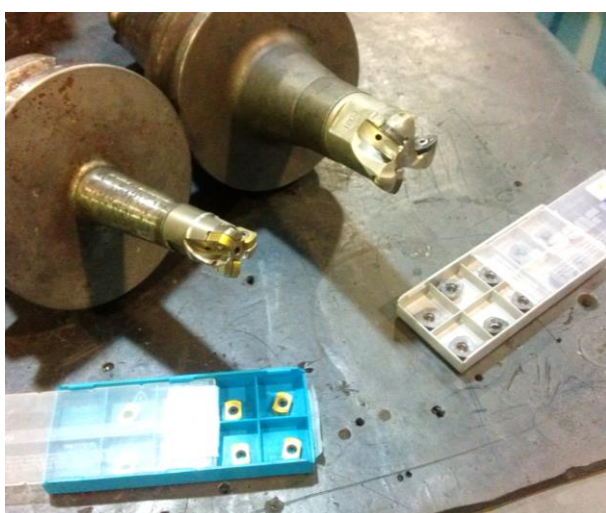
2.11 pav. Pirštinės frezos su keičiamomis plokštelėmis ( kairėje ) ir vientisos ( dešinėje )
