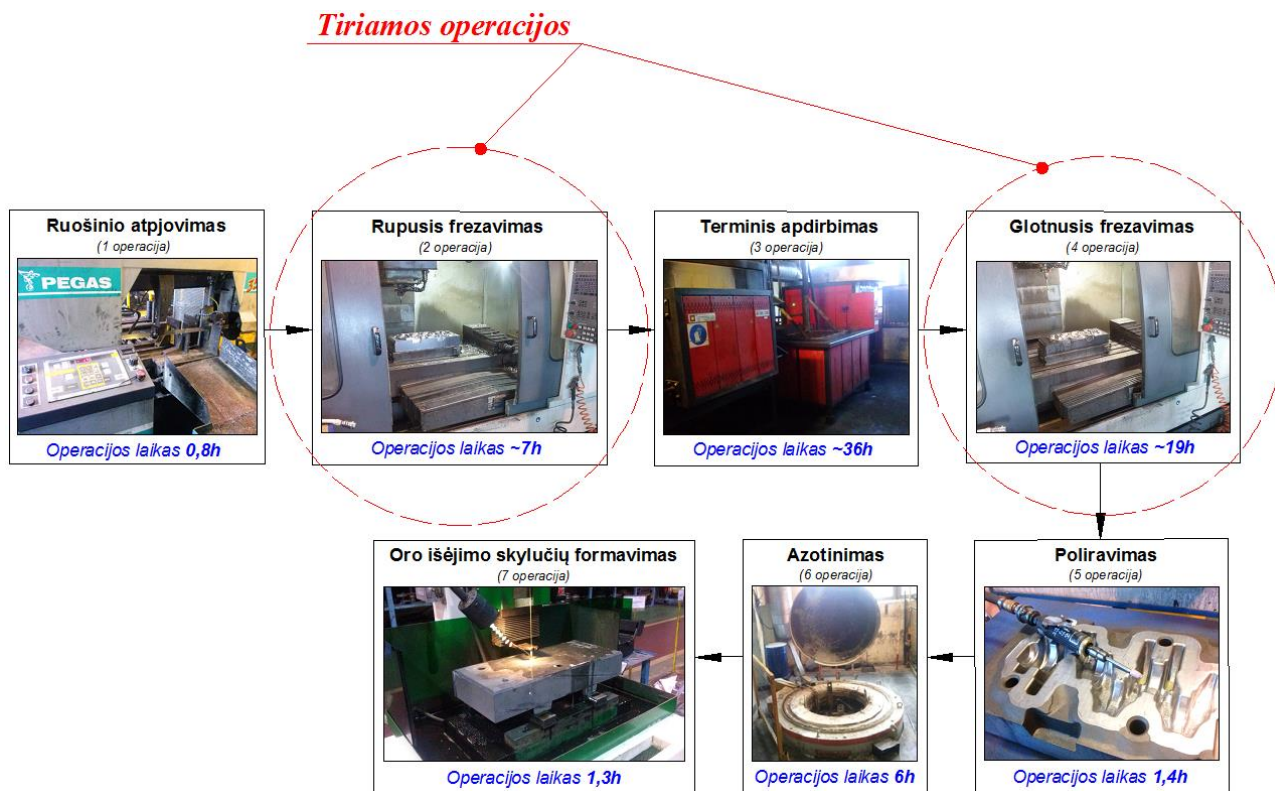
2.1 pav. Šampavimo įdėklų gamybos technologija su operacijų laikais
