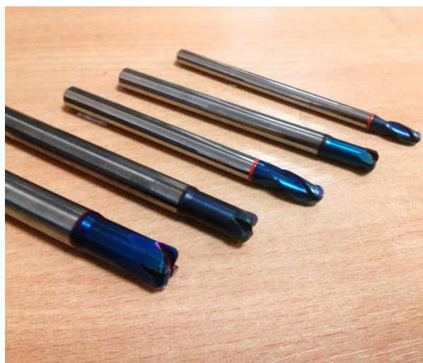
2.11 pav. Pirštinės frezos su keičiamomis plokštelėmis ( kairėje ) ir vientisos ( dešinėje )
