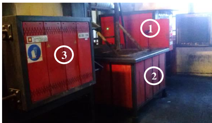
1.18 pav. Terminio apdirbimo linija: 1 – kaitinimo krosnis; 2 – aušinimo vonia; 3 – atleidimo krosnis
