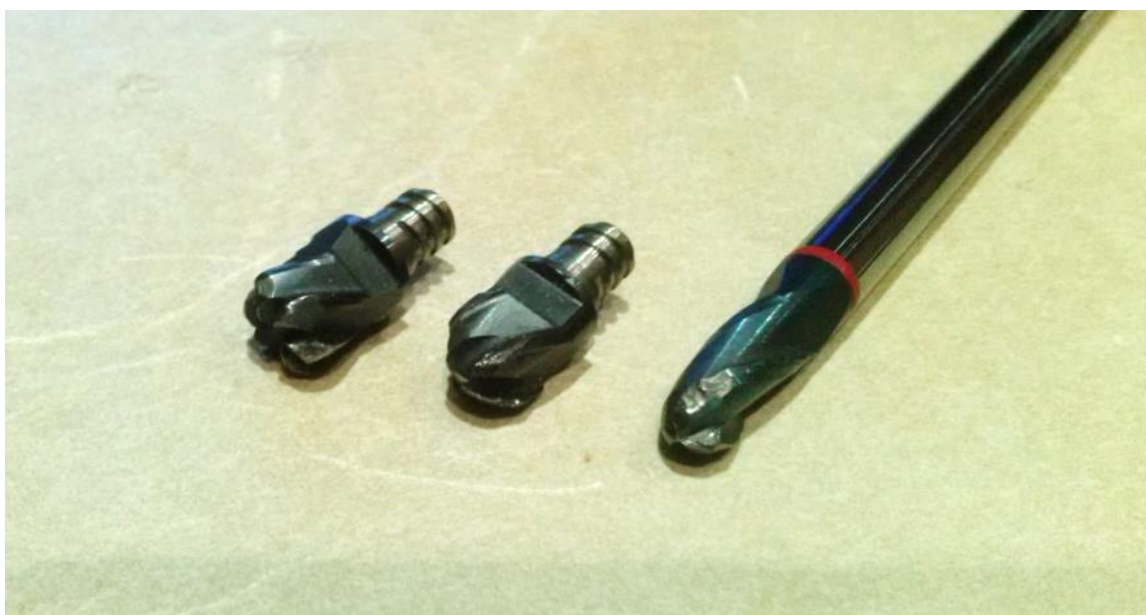
2.32 pav. Naudojant greitintuvus sudilusios 8 mm ir 6 mm skersmens frezos
