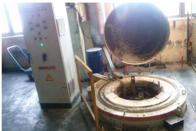
1.20 pav. Azotavimo vonia „Proycotecme“
