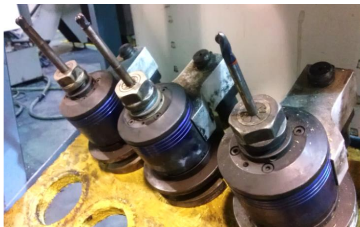
2.31 pav. Surinkti greitintuvai su 8 ir 6 mm skersmens pirštinėmis frezomis
