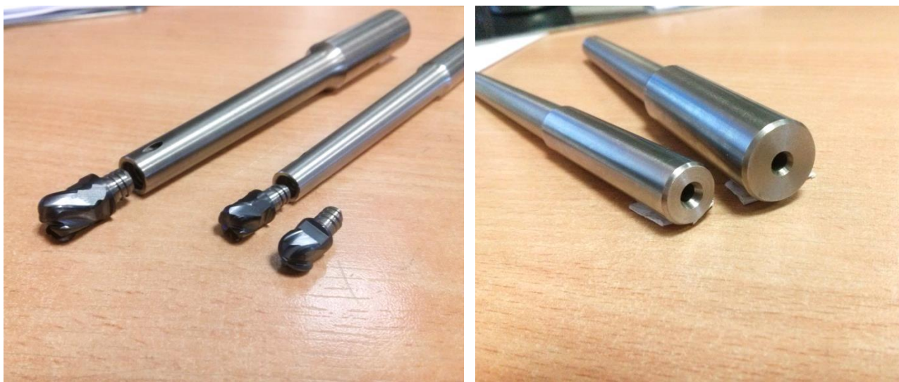
2.25 pav. Pirštinės frezos su keičiamomis kietlydinio galvutėmis ( kairėje ) ir koteliuose esančios ertmės skirtos vidiniam aušinimui ( dešinėje )
