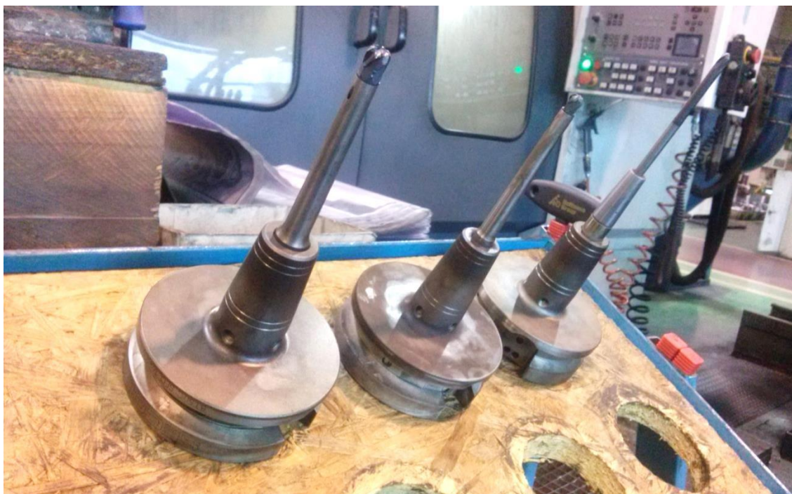
2.37 pav. Surinkti termolaikikliai su 10, 8 ir 6 mm skersmens pirštinėmis frezomis
