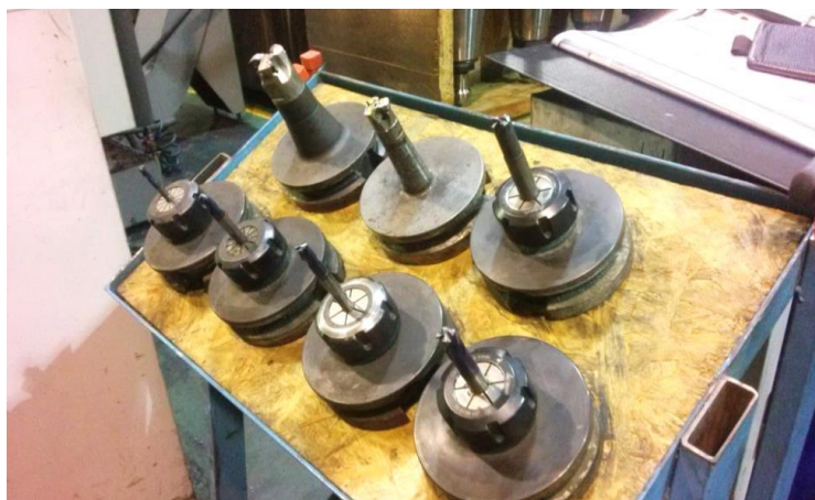
2.10 pav. Rupiujam apdirbimui naudojamos frezos standartiniuose įrankių laikikliuose
