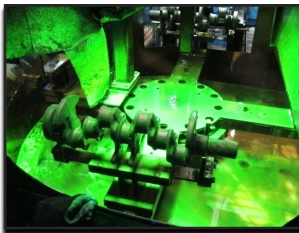
1.11 pav. Mikro įtrūkimų kontrolė „Magnaflux“ įrenginiu
