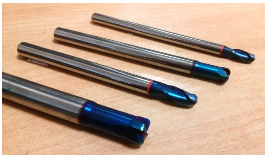
2.21 pav. Glotniajame apdirbime naudojamos pirštinės vientisos frezos
