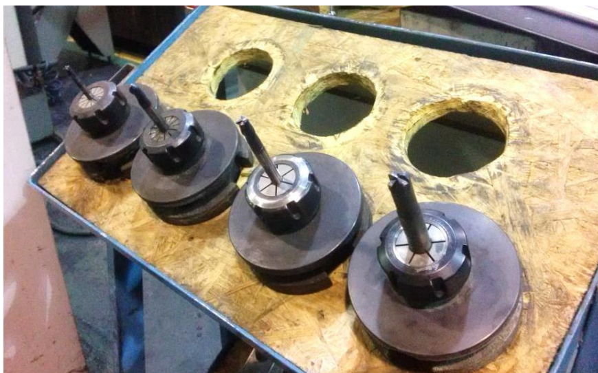
2.20 pav. Glotniajam apdirbimui naudojamos frezos standartiniuose įrankių laikikliuose
