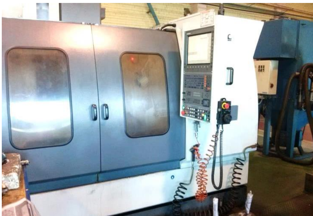
1.17 pav. Universalus programinio valdymo apdirbimo centras „YCM 148B“
