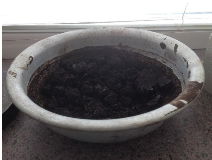
8.3.2 pav. Plazminio pjaustymo metu susidariusio dumblo džiovinimas.
