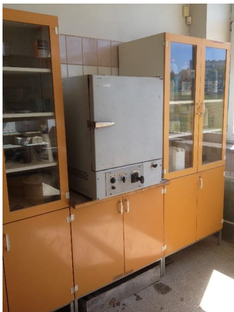
8.3.2 pav. Plazminio pjaustymo metu susidariusio dumblo džiovinimas.
